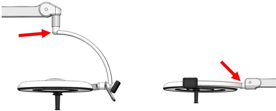
Figura 2. Model cu colier dublu și model cu colier simplu. Articulațiile la care se referă această Notificare privind siguranța în teren sunt marcate cu o săgeată
